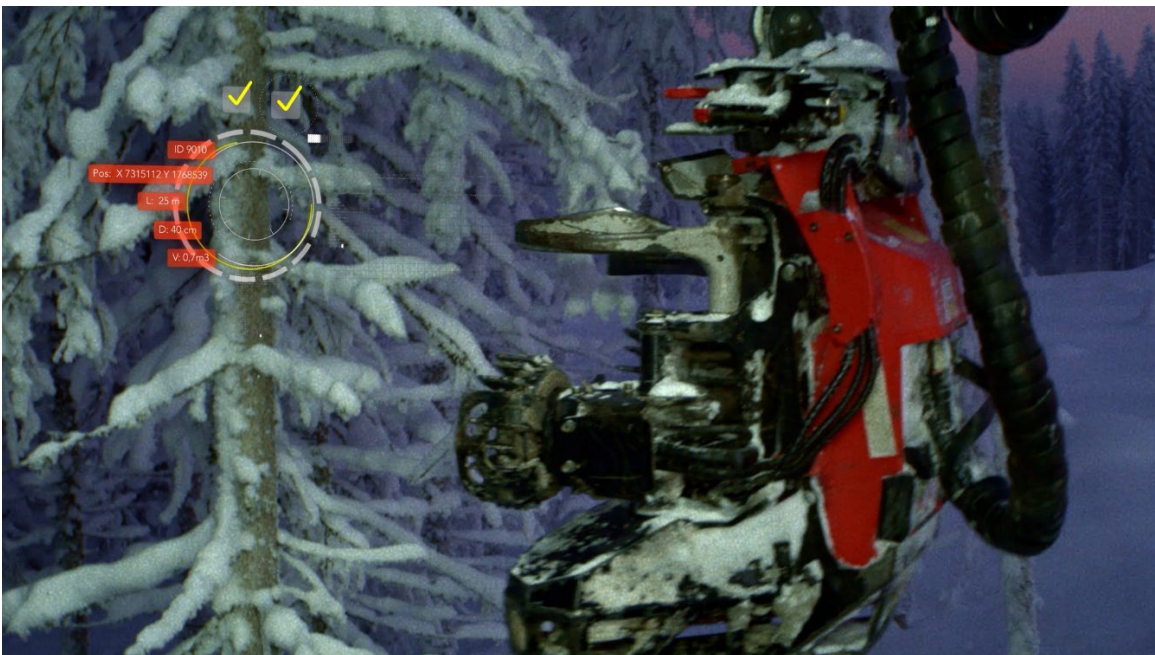
Kuva 1. Tulevaisuuden visio, miten hakkuukoneenkuljettajaa voidaan avustaa ja tukea poistettavien ja toisaalta säästettävien puiden valinnassa tai jopa automatisoida täysin niiden valinta. Lähde: Komatsu Forest Oy.
