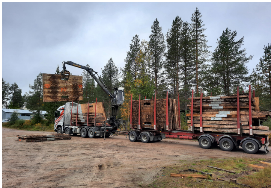
Kuva 2. CLT-levyt kuljetettiin korjuukohteille puutavara-autolla. Täysperävaunukuormaan pystyttiin lastamaan kaikki käytettävissä olleet 35 CLT-levyä. Kuva: Helena Pahkala / Suomen metsäkeskus.
