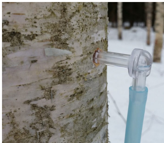
Kuva 1. Mahlan keruuta varten runkoon porattiin 8 mm:n reikä, johon asennettiin holkki. Holkkiin kiinnitetty letku johti mahlan puun tyvellä olevaan astiaan. Astiaan valuneen mahlan määrä mitattiin muutaman päivän välein. Kuvissa on eteläsavolainen istutuskoivikko, jonka ikä on 22 vuotta ja keskiläpimitta 18 cm. Koivikosta valittiin valutukseen kolme eri läpimittaista puuta, joiden mahlasato oli keskimäärin 11,7 litraa vuonna 2019 ja 29,3 litraa vuonna 2020. Kuvat: Jari Miina/Luke.
