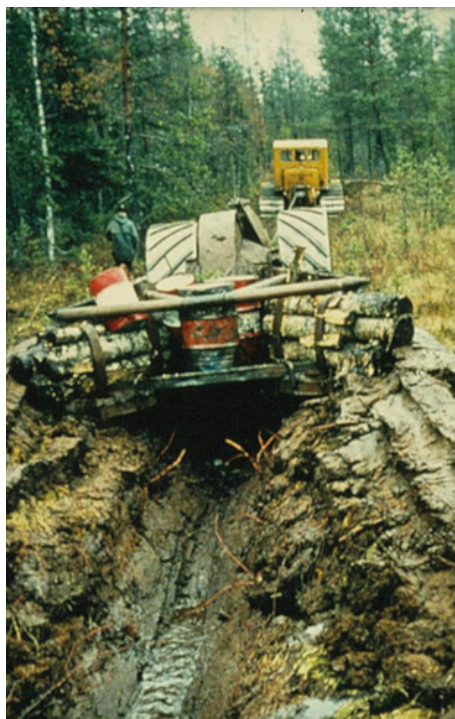
Kuva 5. Ojan auruksessa metsäoja-auraa vedetään vinssin välityksellä levennetyin suoteloin varustetun traktorin pysyessä paikoillaan. Valok. Juhani Päivänen.
