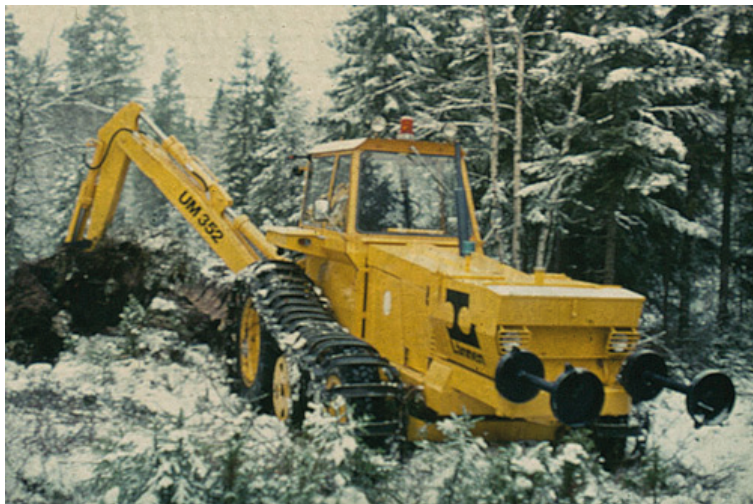
Kuva 6. Metsäojituskaivuri, jossa kevyet suotelat, hydraulinen voimansiirto ja muotokauha. Valok. Juhani Päivänen.
